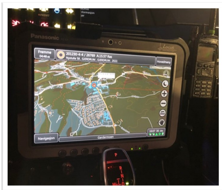
«Locus-skjermen» i brannbilene viser andre brannressurser på stedet, men ikke andre redningsressurser.
